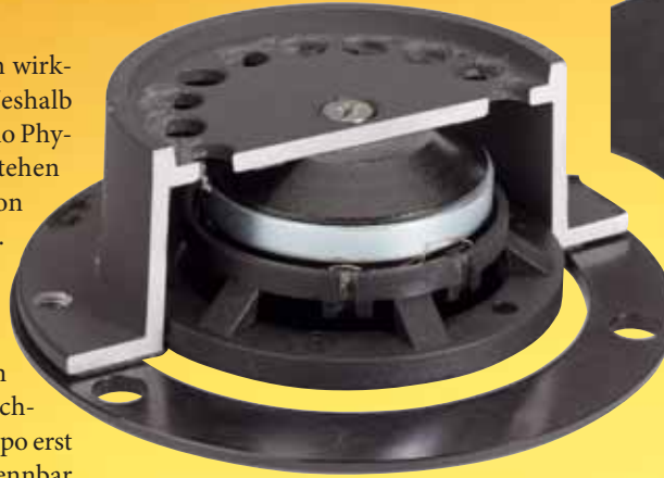
Der „Hyper Holographic Cone Tweeter“ besitzt ein Doppelkorb-System aus Metall und Kunststoff (siehe Schnittmodell links). Er wird speziell befestigt und entkoppelt (s.o.)
